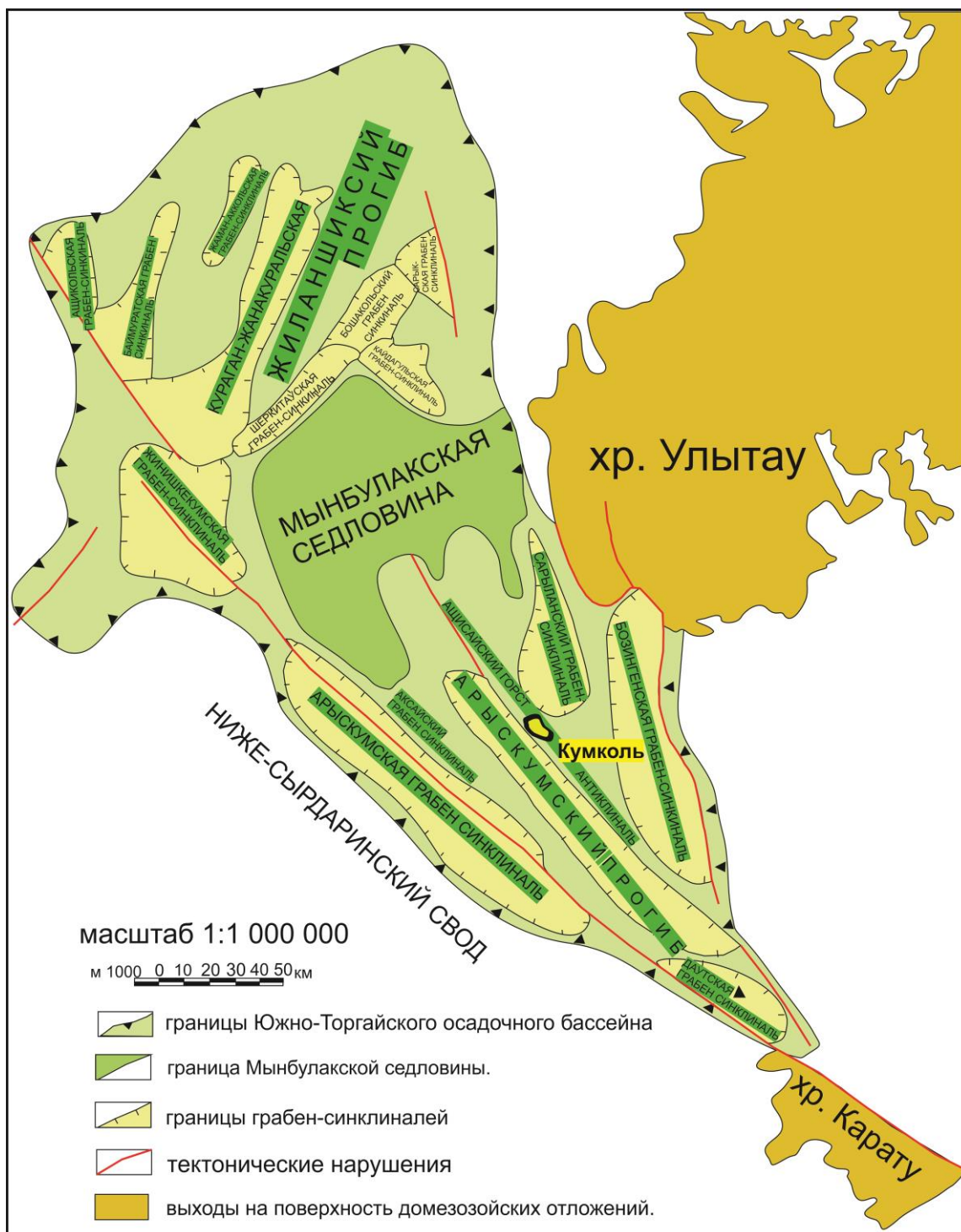
Рисунок 2 - Схема тектонического строения Южно-Торгайского осадочного бассейна
