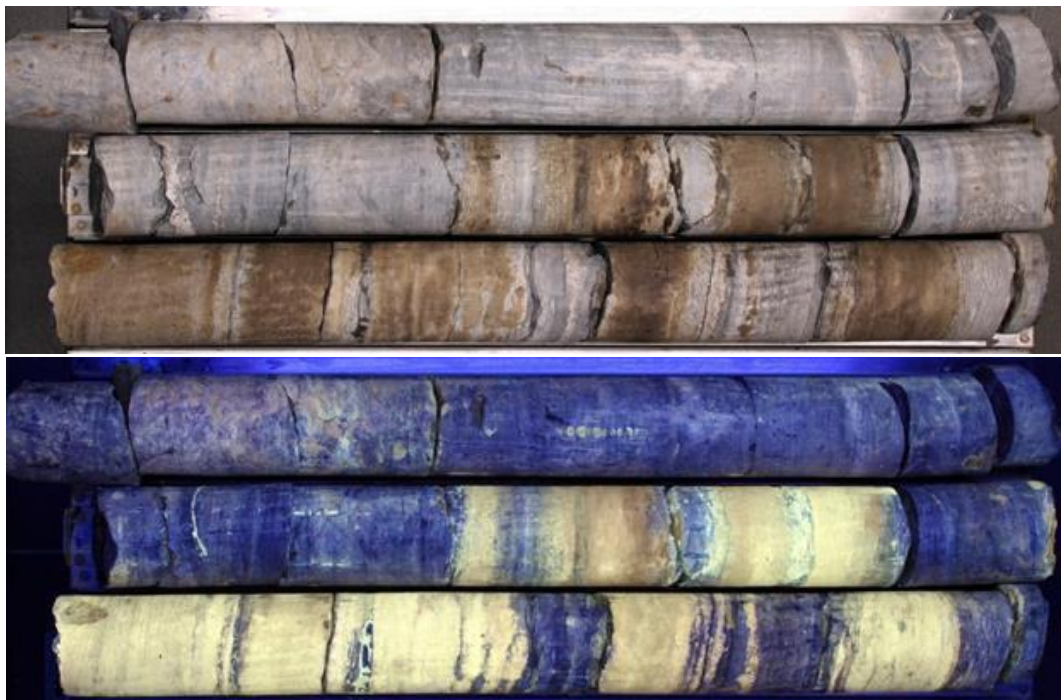
Рисунок 16 – Фото нефтенасыщенного песчаника продуктивного горизонта Ю-III при дневном и в ультрафиолетовом свете. Скв. №165 на интервале 1853-1856 метров
